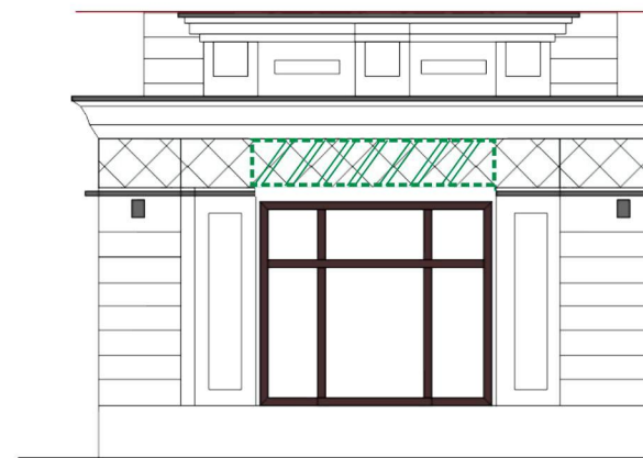
Обозначение вывески и зеленой зоны для нее на схеме размещения вывесок
